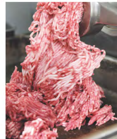
用途に応じて、12mmの超粗挽きから3.2mmの挽肉をあっという間に作り出すミンチマシーン。
